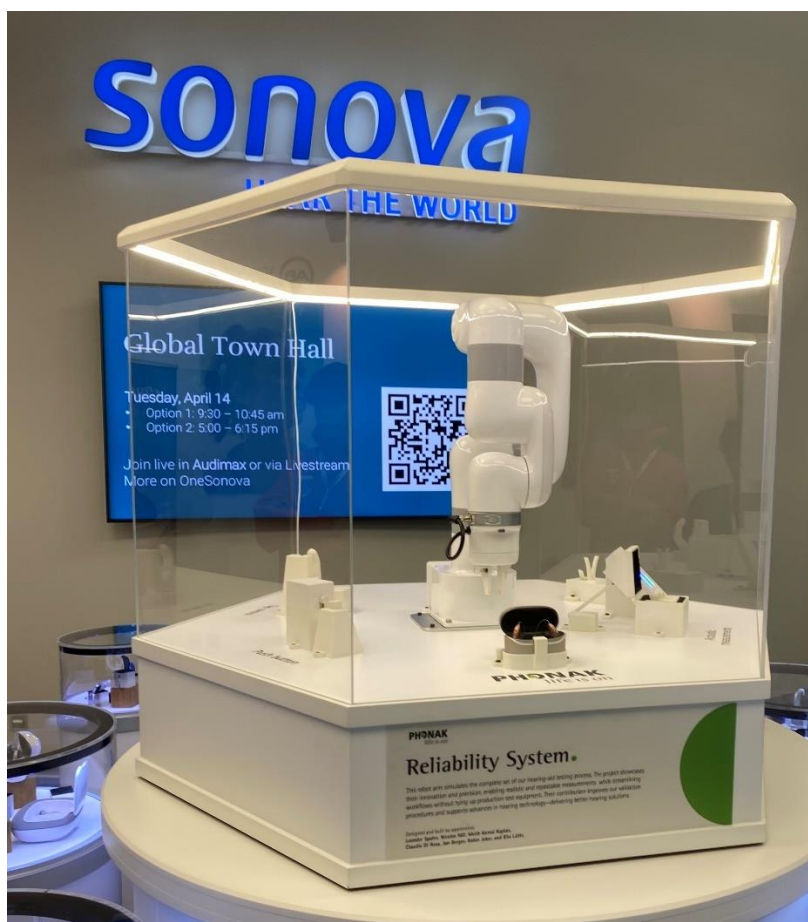
Automatisiertes Reliability-Testsystem für Hörgeräte bei der Sonova AG.
